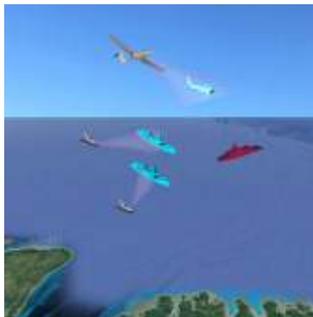
Figura 2: VANT e VSNT utilizam a técnica de despistamento eletrônico para criar alvos falsos para enganar os radares de busca e vigilância do navio hostil.
